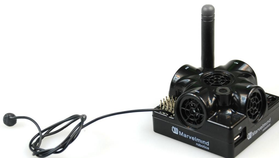
图 1：连接一个 External Microphone 的 Super-Beacon
