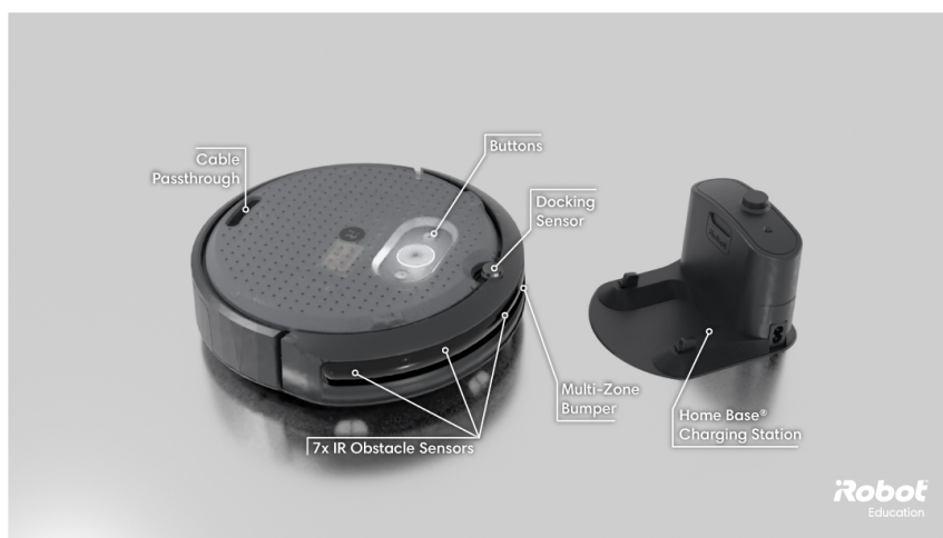
Figura 2.5 Vista general Create 3 y base de carga. Se representa la parte frontal de la roomba, donde se encuentran los 7 sensores infrarrojos y los bumpers.
