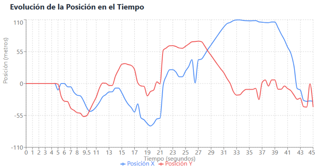
Figura 4.7 Evolución de la Posición en el Tiempo (Odometría interna).
