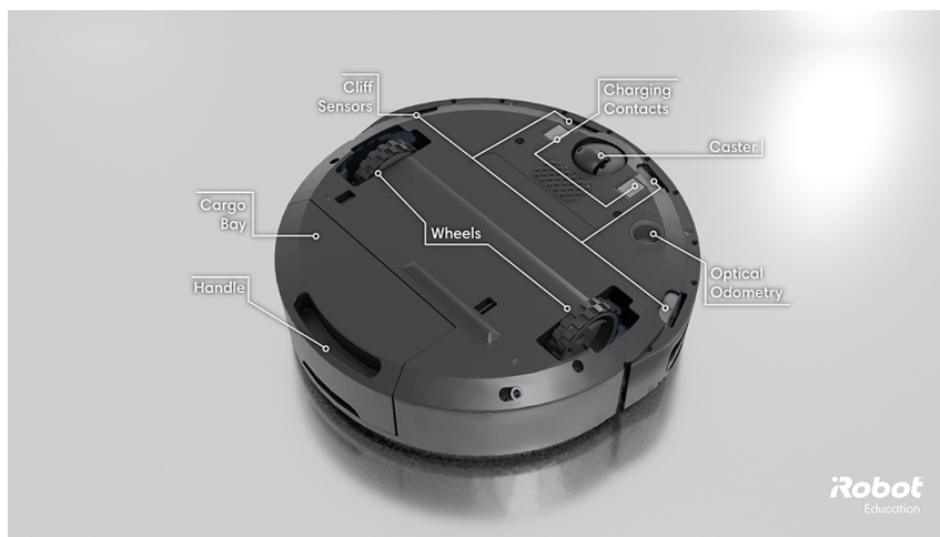
Figura 2.4 Vista inferior Create 3. En esta imagen se observan claramente algunas de las partes esenciales para la odometría: las dos ruedas motrices con encoders integrados, así como sensores de corriente (current sensors) conectados a ellas.
